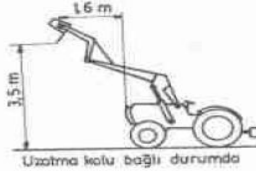
Şekil 68. Traktör önyükleyicilerinde yükleme yüksekliği ve boşaltma aralığı.
